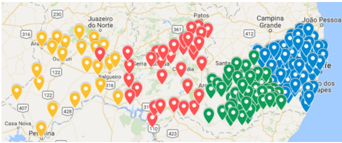
Figura 4: Ilustração do processo de clusterização aplicado em [36] para auxiliar no projeto de uma rede óptica para o estado de Pernambuco. No exemplo são requeridos 4 agrupamentos.
